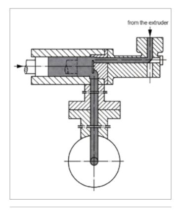
Figure 17: Ram Accumulator (design: Siemag, Hilchenbach/Dahlbruch)
